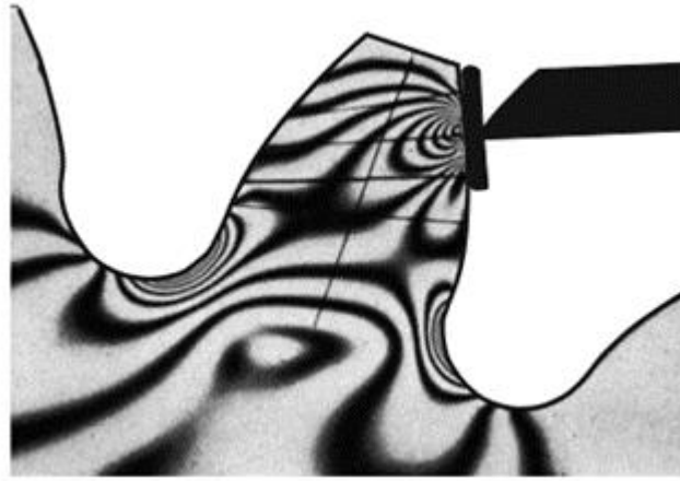
Figura 2.4: Distribución de tensiones típica de un diente donde se identifican las más relevantes, tensión de flexión en el entalle y la tensión de contacto producida en la zona de contacto. (Fuente: [41]).
