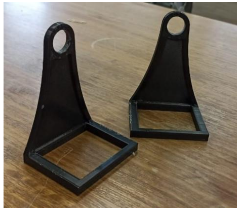
Figura 3.8: Pieza auxiliar bloqueo de rodadura impresa en PLA. Al ser solidaria al cilindro bloquea la rodadura al entrar en contacto por la superficie inferior del banco de ensayos.
