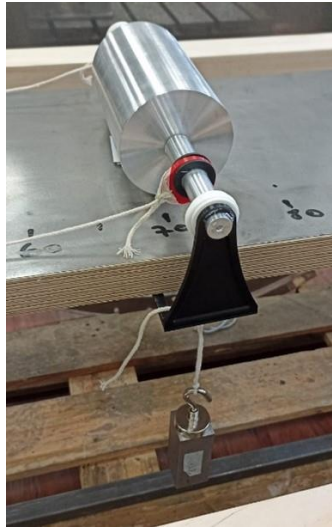
Figura 3.9: Pieza auxiliar instalada en el banco de ensayos. Para lograr el movimiento se debe aplicar una fuerza mínima de magnitud \mu\text{N} , siendo N la suma del peso del cilindro y el colgado.
