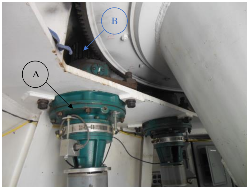
Figura 12: Estructura interna del radiotelescopio. Se muestran los reductores de velocidad (A) y el juego de engranajes (B) [16]
