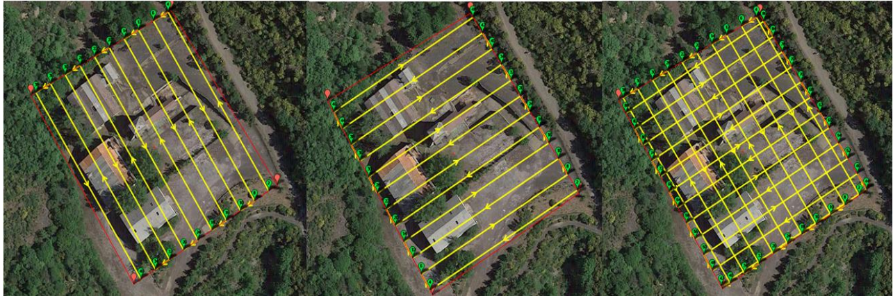
Ilustración 20 Planes de vuelo fotogramétrico tradicional, tradicional en dirección perpendicular y cuadrícula regular. Elaboración propia.
