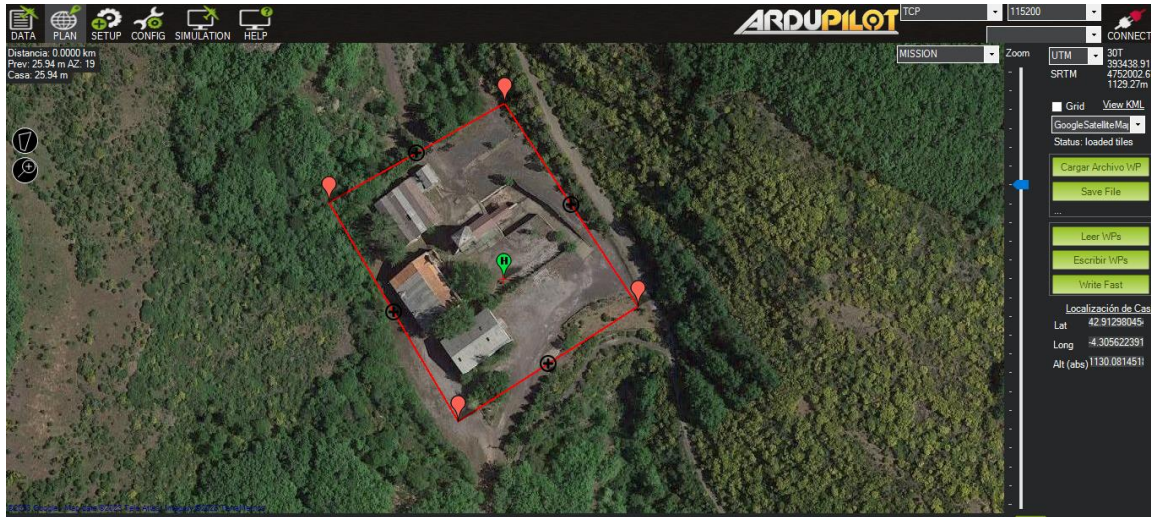
Ilustración 28 Selección del polígono en el área de interés en Mission Planner. Elaboración propia.
