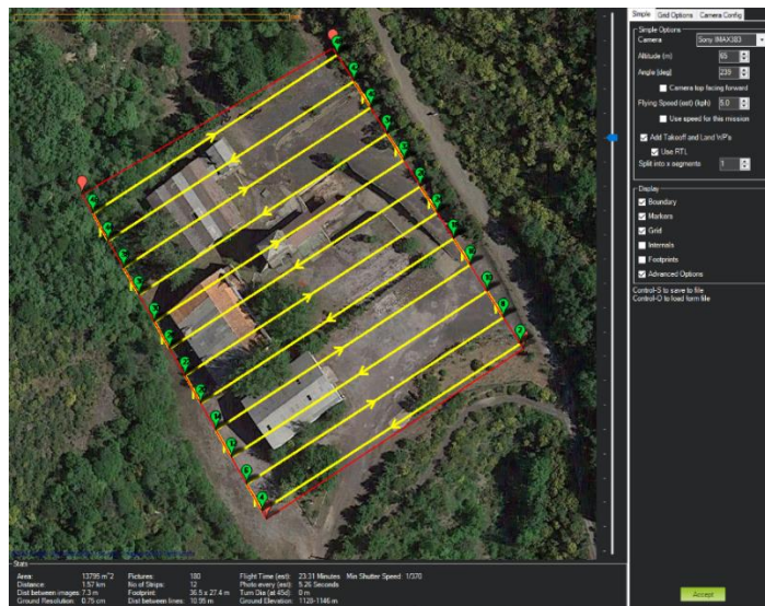
Ilustración 31 Parámetros generales y estadísticas del proyecto de vuelo fotogramétrico con pasada en dirección perpendicular en Mission Planner. Elaboración propia.
