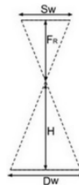
Ilustración 5 Relación de altura de vuelo. Extraído de Pix4d User Manual
