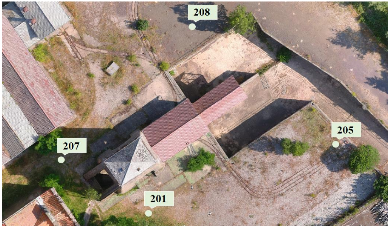
Ilustración 22 Disposición puntos de control de precisión. Elaboración propia.
