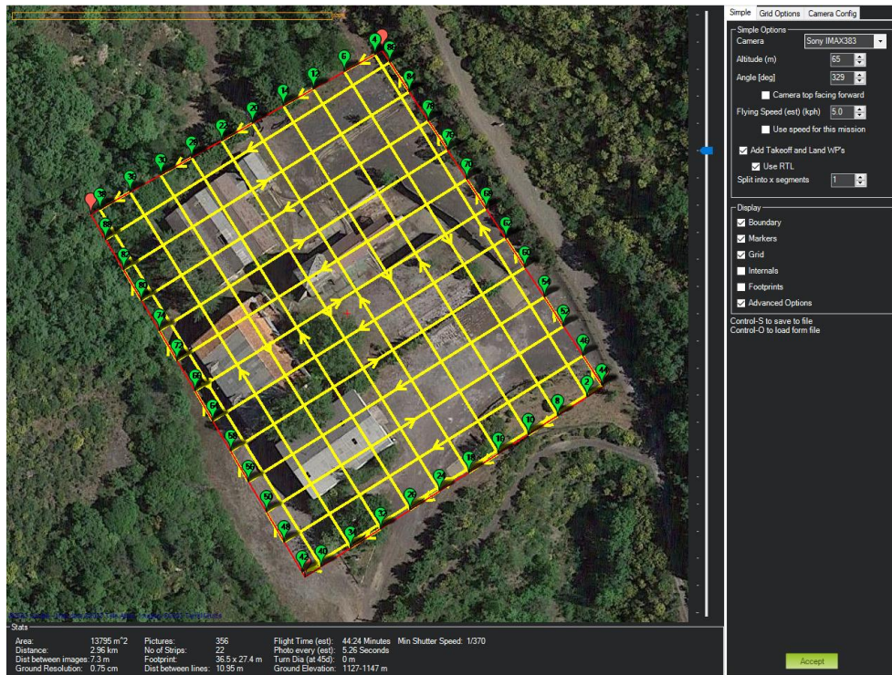
Ilustración 32 Parámetros generales y estadísticas del proyecto de vuelo fotogramétrico con pasada cuadrícula regular en Mission Planner. Elaboración propia.
