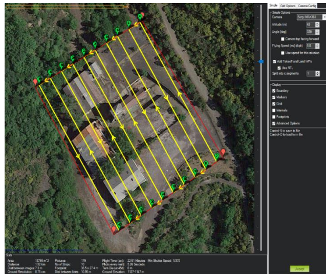
Ilustración 30 Parámetros generales y estadísticas del proyecto de vuelo fotogramétrico con pasada tradicional en Mission Planner. Elaboración propia.
