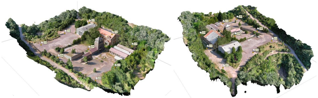
Ilustración 58 Vistas malla texturizada pasada cuadrícula. Elaboración propia.
