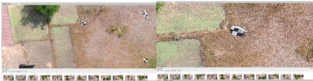
Ilustración 42 Ajuste manual de los puntos de apoyo en las imágenes. Elaboración propia.
