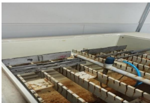
Figura 28. Piezas A y B montadas en la cámara de niebla salina
