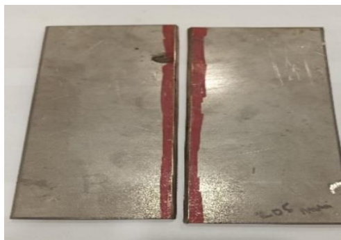
Figura 17. Proceso de corte en plancha AISI 304L para obtención de muestras experimentales
