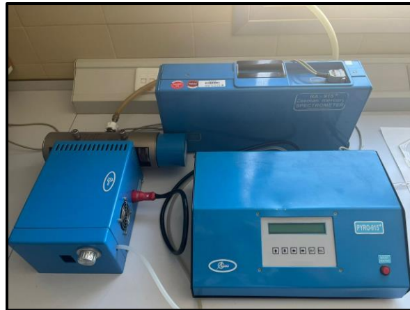
Ilustración 15. Equipo LUMEX RA-915+.
