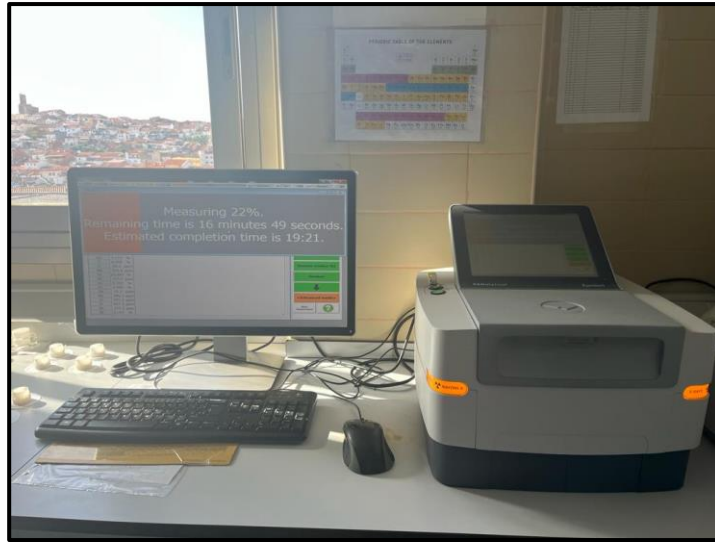
Ilustración 25. Equipo de medición Malvern Panalytical Epsilon 1.
