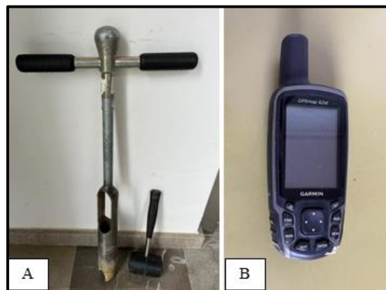
Ilustración 3. A: Barrena de suelo de la marca Ejkelkamp; B: GPS portátil GARMIN GPSmap 62 st.
