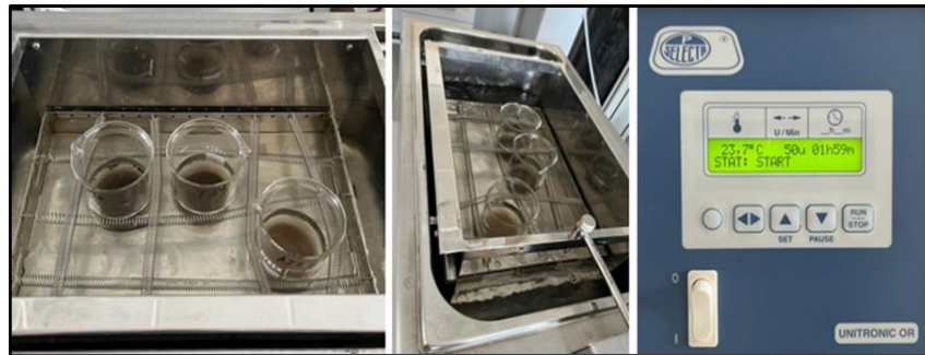
Ilustración 13. Baño de agitación con sus parámetros a utilizar.
