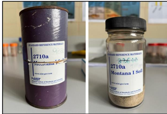
Ilustración 27. Estándares “Montana Soil” utilizados para la calibración del equipo LUMEX RA-915+.
