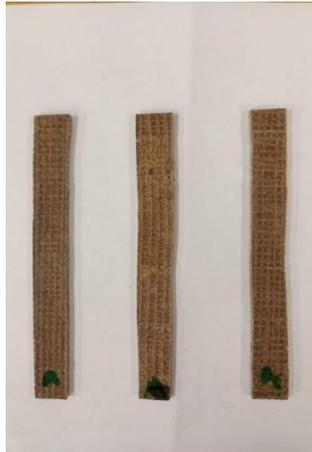
**Figura 4.26: Probetas RFA flexión: 1, 3 y 5 por ciento contenido particulado (izquierda a derecha)**
