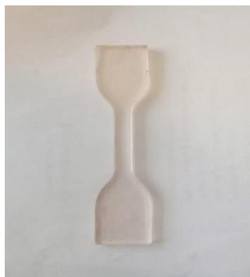
**Figura 4.15: Probeta de resina para ensayo de tracción**
