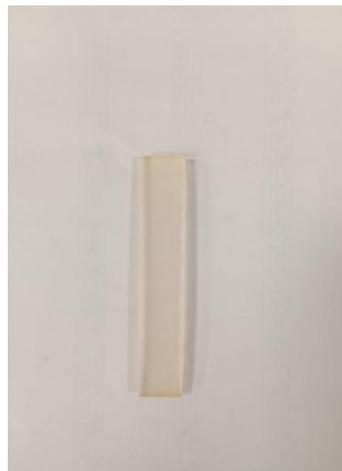
**Figura 4.21: Probeta de resina para ensayo de flexión**
