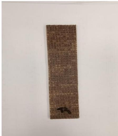
**Figura 4.19:** Probetas RF tracción
