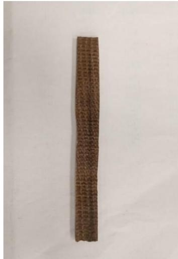
Figura 4.24: Probeta RF para ensayo de flexión
