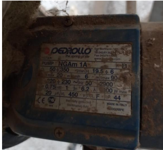
Figura 3.3: Bomba centrífuga utilizada. Fuente propia
