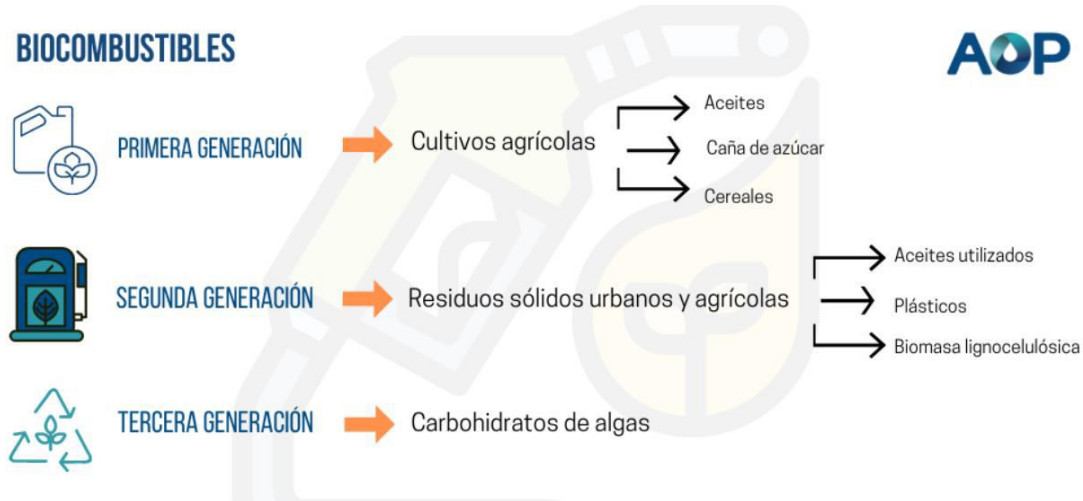
Figura 2.1: Diagrama de clasificación biocombustibles.
