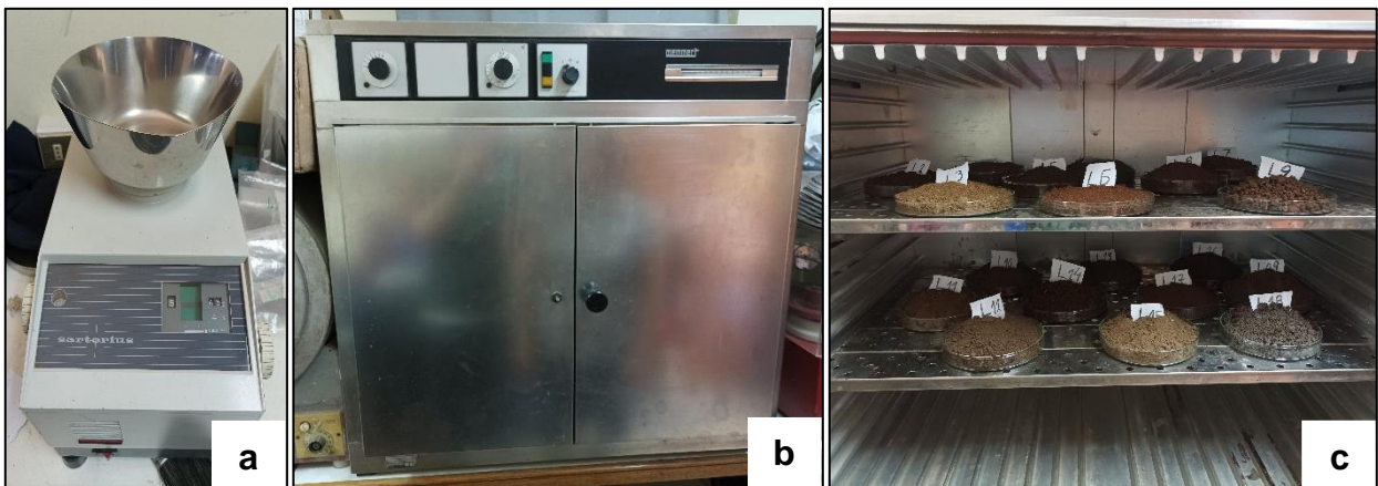
Fotografía 4.5 Instrumentos utilizados durante etapa de preparación de las muestras para la medición en muestra seca. En a) Balanza manual, b) Horno de secado de convección natural y c) Muestras ingresadas al horno.
