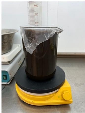
*Figura 7.1: Hidrólisis alcalina para extracción de EPS a partir de lodos sanitarios.*
