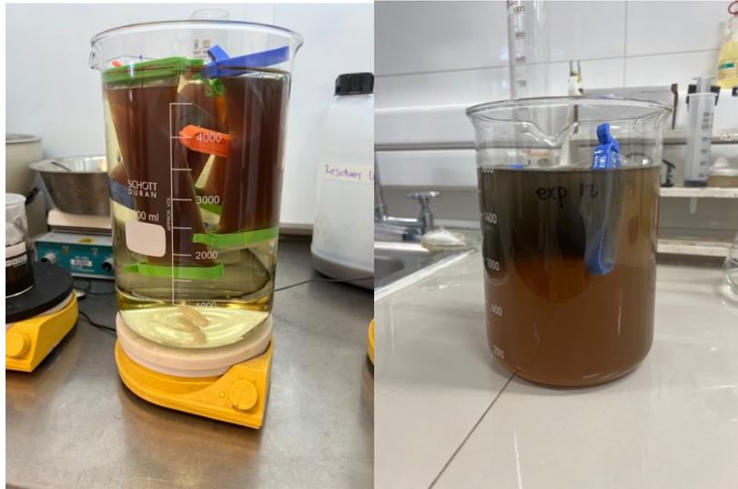
Figura 7.4: Sistema de membranas de diálisis con peso molecular de corte de 3500 Da
