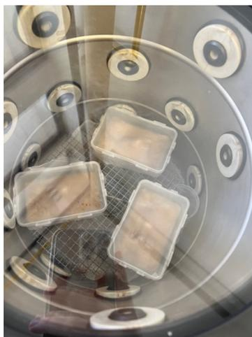
Figura 7.5: Extractos de EPS en liofilizador
