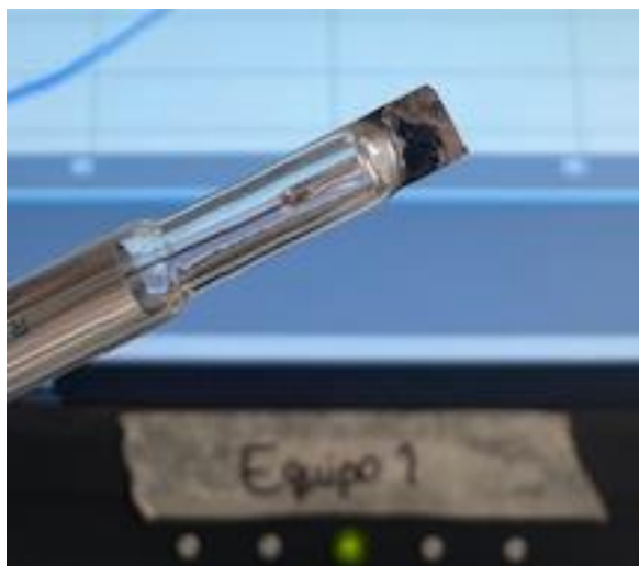
Figura 24. Electrodeposición de telurio metálico al trabajar a una razón de 15.3 Se/Te.
