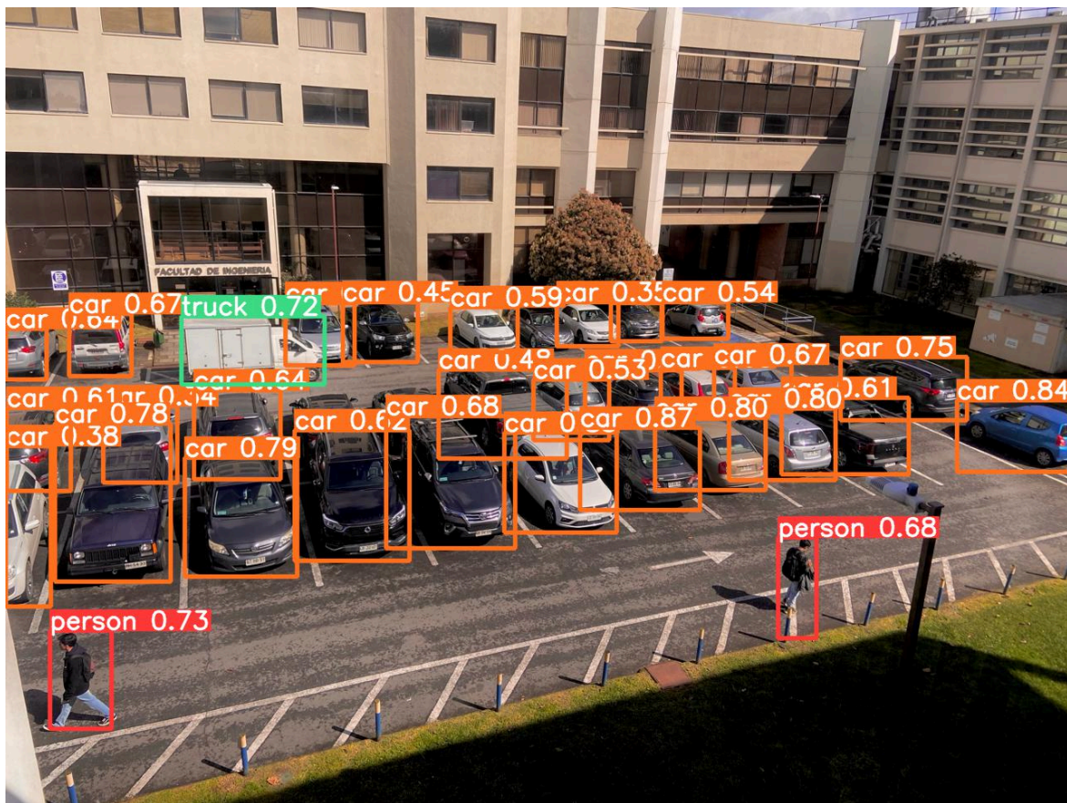
Figura 9. Resultados de la cámara 1. 29 aciertos de 32 vehículos en la imagen.
