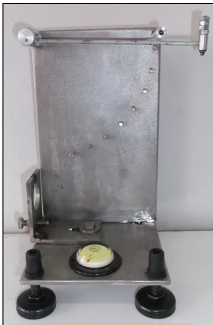
Figura 4. Dispositivo utilizado para originar el daño por impacto en cerezas, cuya energía de impacto al ser dejado caer desde un ángulo de 90° es de 0,0107 J.
