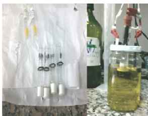
Figura 19. Materiales electroquímicos. a) Celdas de membrana (lado izquierdo), b) Sistema electroquímico compuesto por la celda de membrana y una celda de disolución de dicromato de potasio en pH 2.0, (lado derecho).
