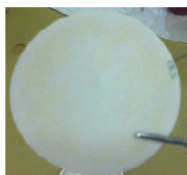
Figura 78. Membrana MPCIVBTA6% después de haber estado en contacto con una disolución de 5 \times 10^{-4} mol/L Cr(VI) en pH 9.0.
