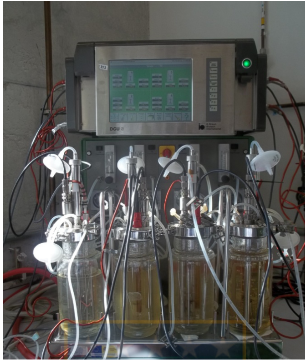
Figura 7 Cultivo de micelio en biorreactor Biostat C Cubas de 1 L.
