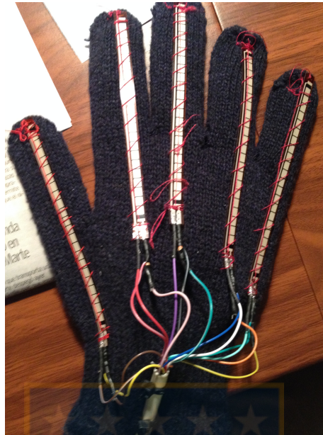
Figura 25: Guante para medir Flexión-Extensión de cada dedo de la mano.
