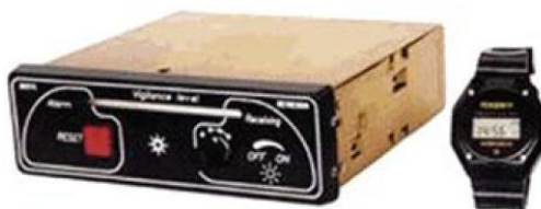
Fig. 2 Se observa el dispositivo "Engine Driver/Driver Vigilance Telemetric Control System", a la derecha se observa el reloj donde se encuentran los electrodos [5].
