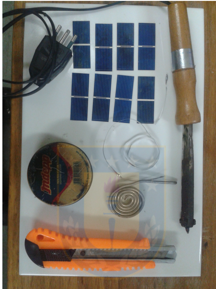
Figura 1: Materiales usados para hacer la celda solar de silicio en modulo
