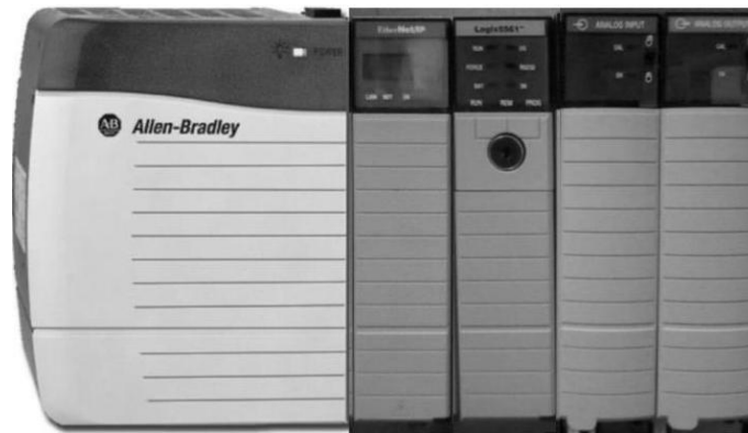
Figura B.1. PLC Allen-Bradley ControlLogix 1756-A7/A
