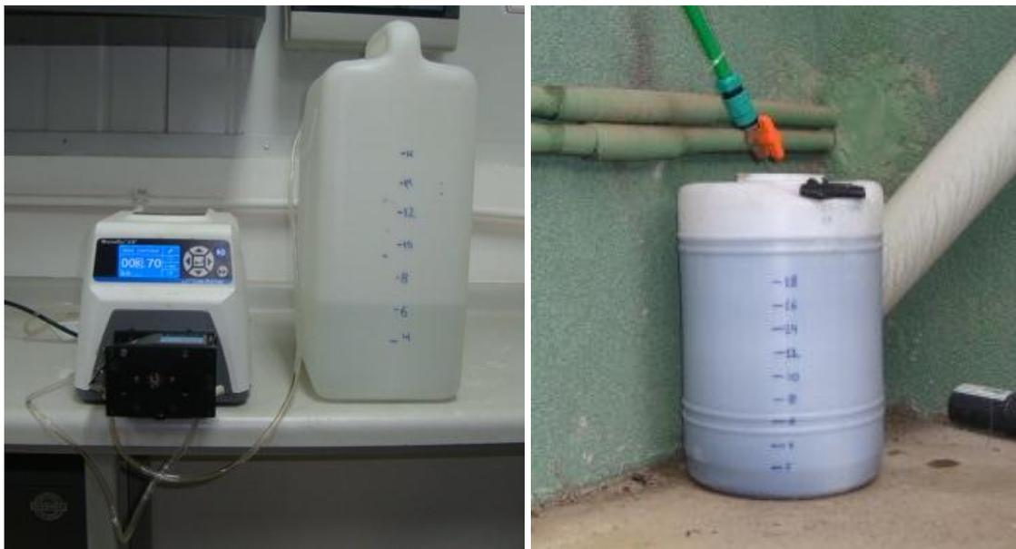
Figura 6.1 Bomba peristáltica, estanque de alimentación (izquierda) y de recepción efluente (derecha)
