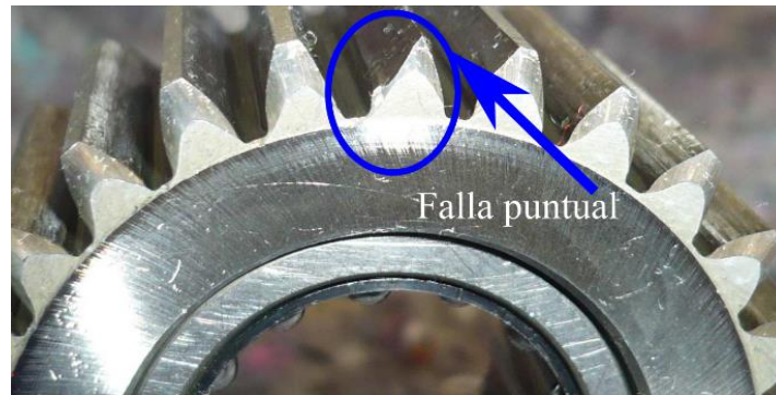
Figura 3.22. Falla puntual en el flanco del diente de un planeta de BE1 [Molina 2010].
