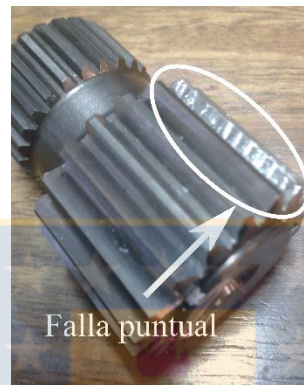
Figura 3.28. Falla puntual en el flanco del diente del sol de BE2.
