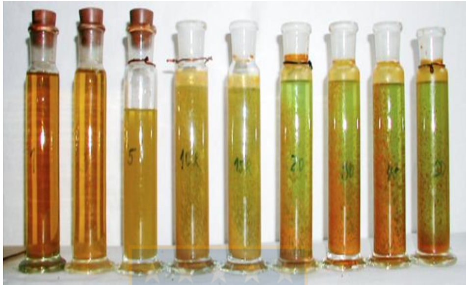
Figura 10.2: Precipitación hidrolítica de goethita desde la lixiviación para diferentes tiempo de lixiviación.
