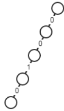
Figura 2.1: Cuatro nodos tienen que crearse para almacenar el 0010
