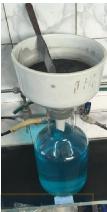
Figura 7. Filtración de la borra resultante de una segunda lixiviación realizada con un Kitasato y una bomba de vacío.
