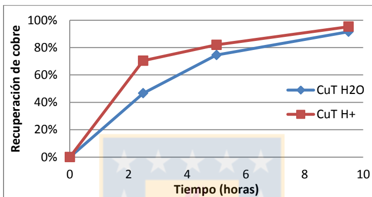
Figura 19. Disolución del cobre de polvos ZT a lo largo de las tres etapas de lixiviación con distintos agentes lixiviantes para la etapa primaria.
