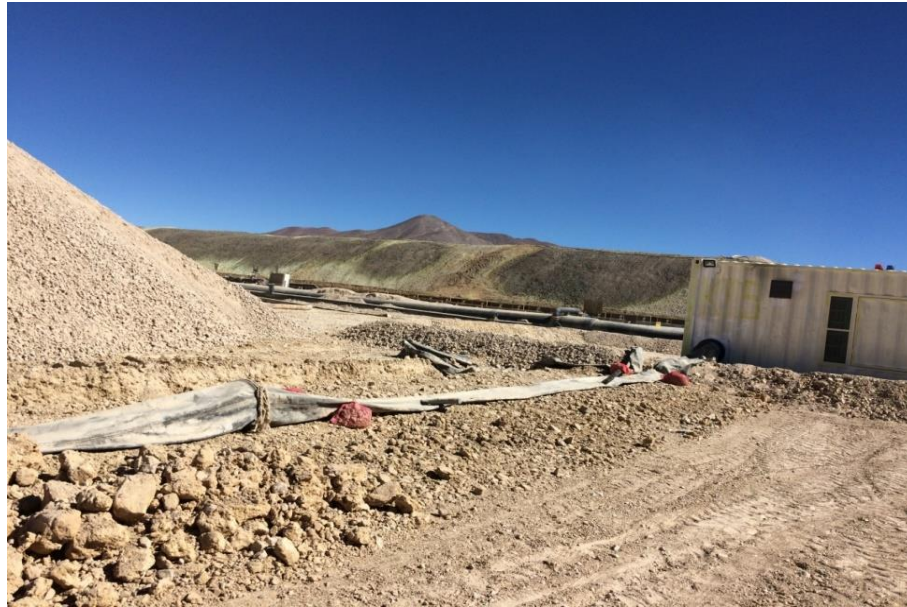
Figura 14. Imagen de un kit de aireación instalado a un costado de la pila con su respectiva manga de distribución de aire forzado. Fuente: Elaboración propia.
