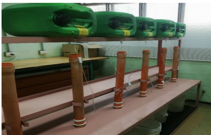
Figura 14: Montaje columnas de lixiviación, Laboratorio Químico Potrerillos.
