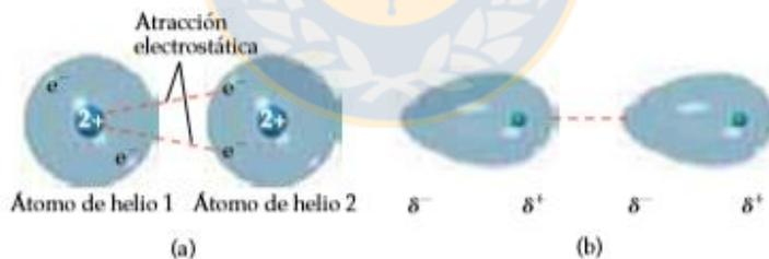
Figura 68: Representación de dipolos instantáneos en dos átomos de helio adyacentes, indican la atracción electrostática entre ellos.
