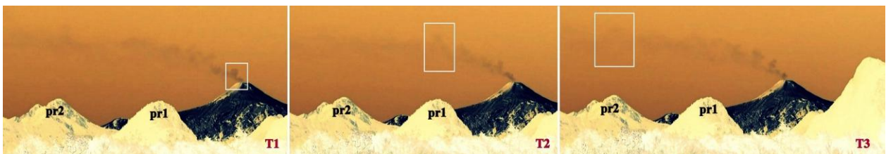
Fig. 12. Imágenes correspondientes a un registro de video utilizado en este trabajo (03 de Septiembre de 2015). Las imágenes representan tres tiempos donde se identifica la misma parcela de gas en: [T1] cráter, [T2] punto de referencia 1 (pr1) y [T3] punto de referencia 2 (pr2).
