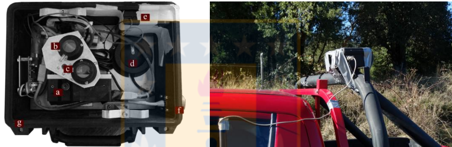
Fig. 8. [a]Espectrómetro [b] Celda de calibración de baja concentración [c] Celda de calibración de alta concentración [d] GPS [e] Baterías para motor rotatorio de celdas [f] Salida de cable USB [g] Maleta. A la derecha se muestra el modo de empleo del instrumento, apuntando al cielo.
