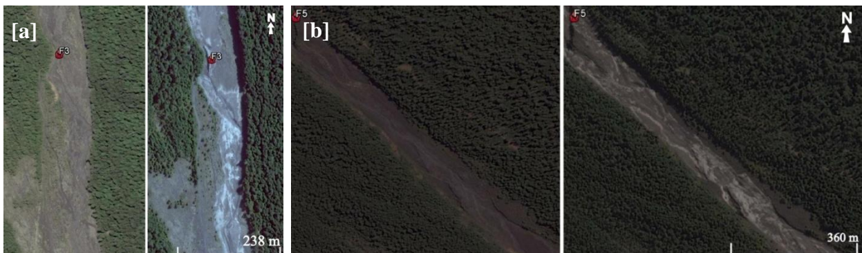
Fig. 40. Imágenes satelitales de las condiciones pre y post-lahar en el cauce del estero ([a] cota ~ 800 m s.n.m., [b] cota ~ 1.100 m s.n.m.).
