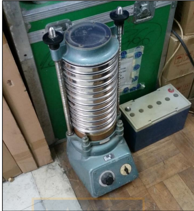
Fotografía 2.1: Agitador eléctrico (Ro-Tap) con tamices.
