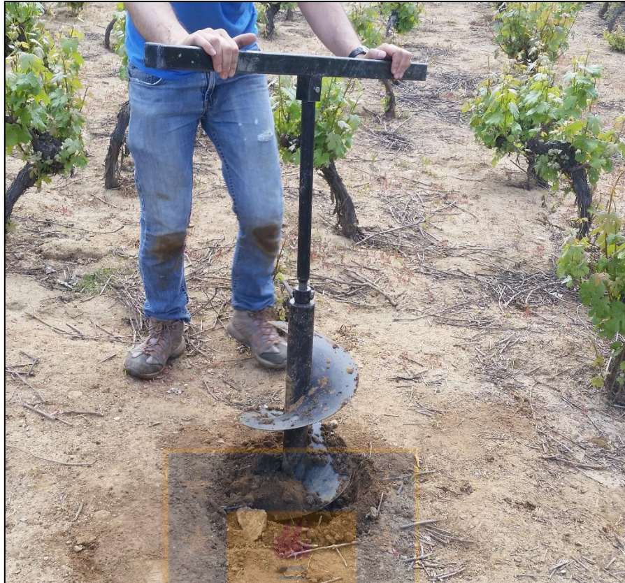
Fotografía 2.3: Perforación de pozo con barreno Auger.
