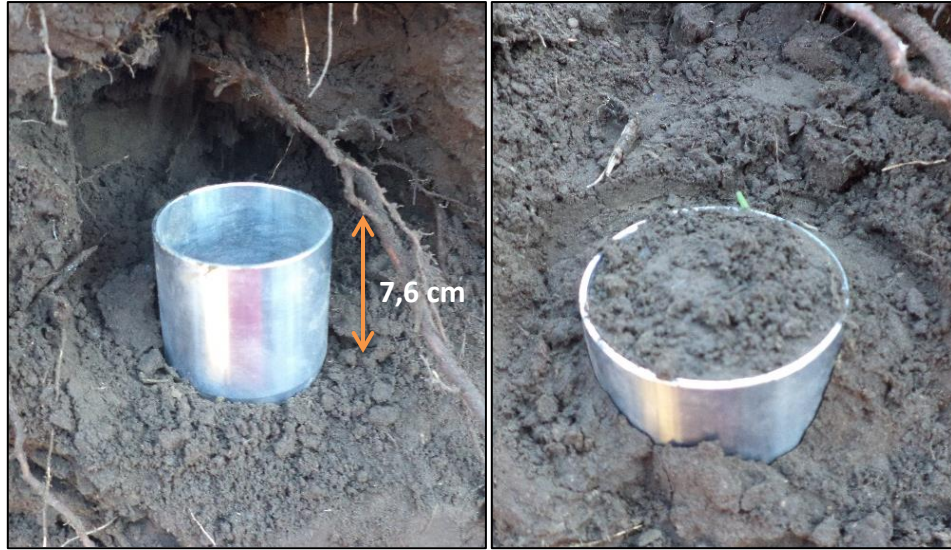
Fotografía 2.6: Cilindro tipo Uhlund. Foto tomada en Viña Turquía Norte.
