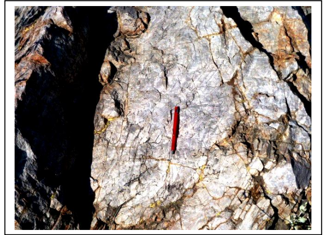
Fotografía 1. Rocas andesíticas con silicificación intensa. Textura bandeada en aureola de contacto.
