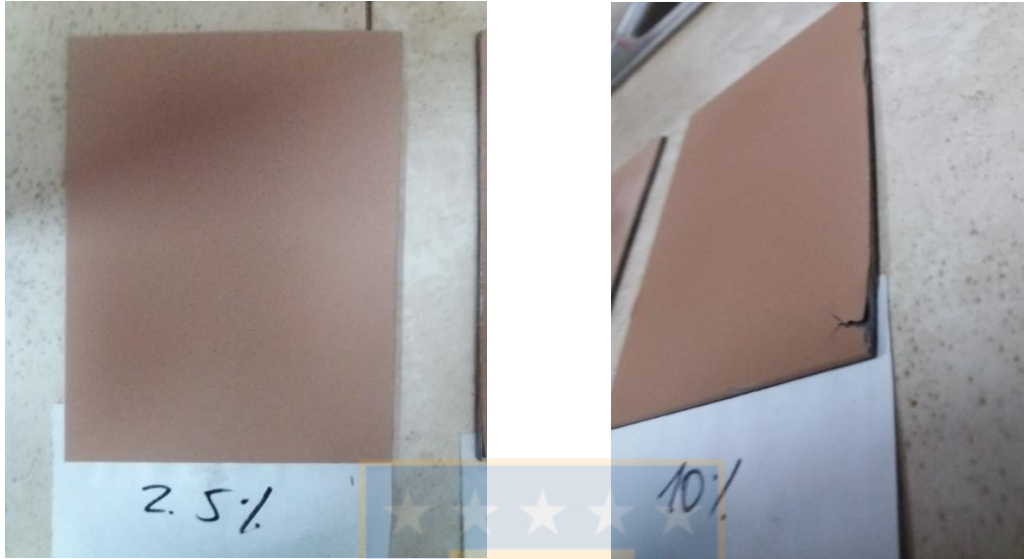
Figura 8.3: Placas de acero pintadas con PU y 2.5% y 10% de polirol comercial LHT 112. Fuente: Elaboración propia.
