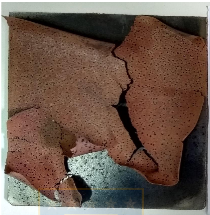
Figura 8.9: Placa con tratamiento SP1+SP3 y pintada con PU. Fuente: Elaboración propia.
