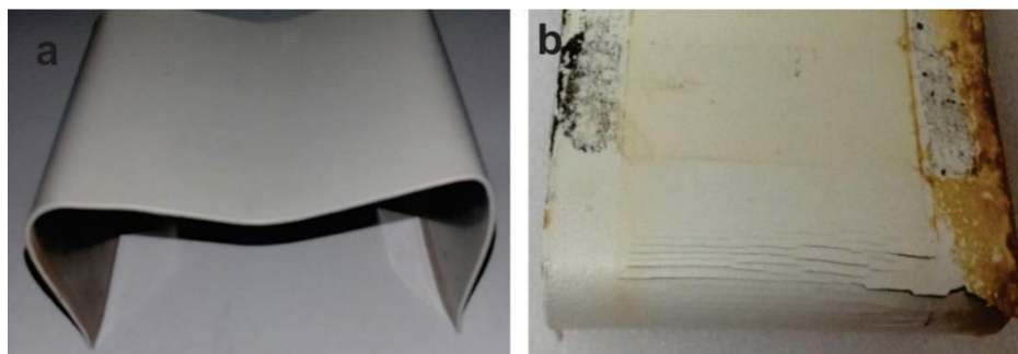
Figura 5.6: Ensayo de flexibilidad a) Probetas a 0 h de exposición ensayo de prohesión b) Probeta a 1000 h de exposición ensayo de prohesión. Fuente: Elaboración propia.
