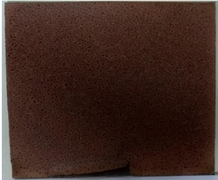
Figura 8.7: Placa con tratamiento SP1+SP2 y pintada con PU. Fuente: Elaboración propia.
