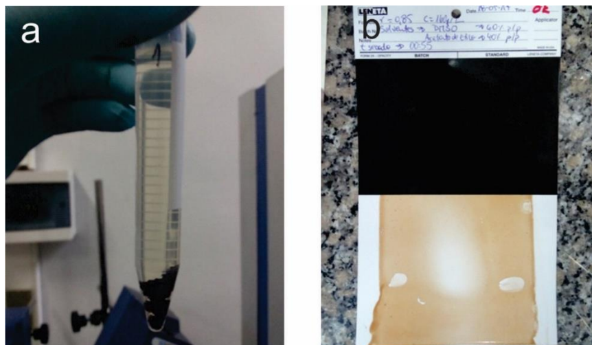
Figura 3.5: a) relación másica de solvente de 90% acetato de etilo y 10% de DMSO, MDI y TS con una relación molar NCO/OH r=0.85 , b) aplicación de mezcla sobre leneta. Fuente: Elaboración propia.
