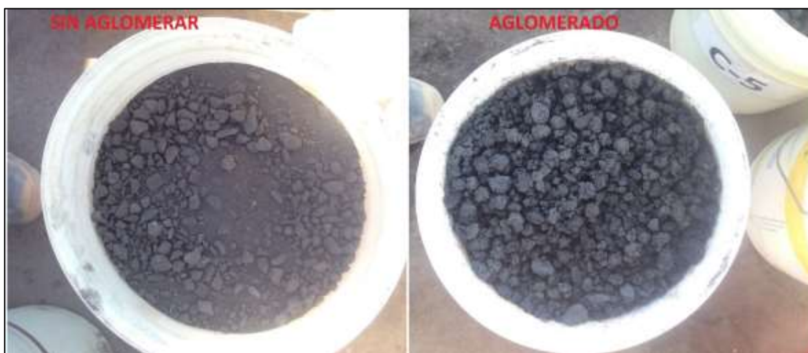
Figura 7. Comparación mineral "Dominio" sin aglomerar y aglomerado, Planta de Óxidos, Las Cenizas, Taltal.
