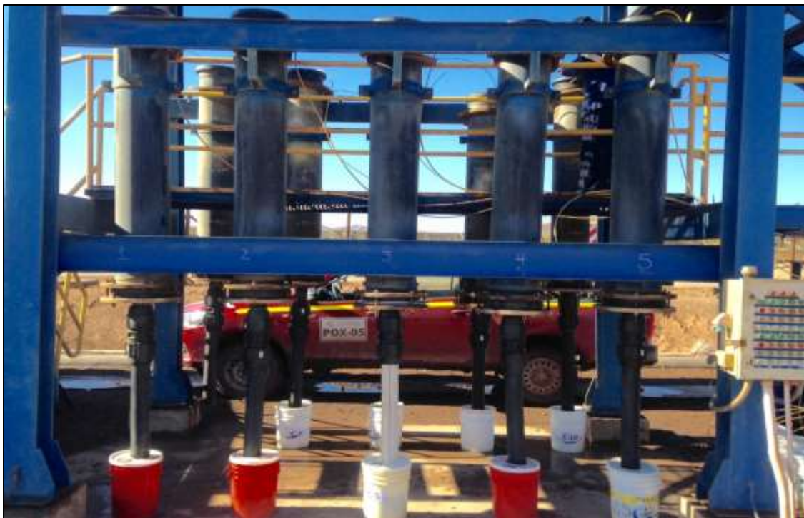
Figura 14. Columnas de lixiviación. Compañía Minera Las Cenizas, Planta de Óxidos, Taltal.
