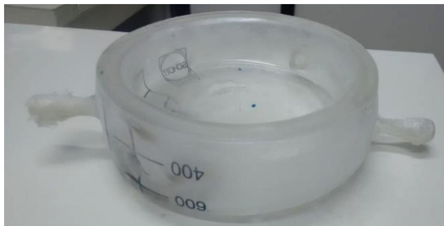
Figura 7. Dispositivo tipo vaso precipitado de doble pared confeccionado para el C/D de capilares conteniendo extractos citosólicos. Fuente: Elaboración propia
