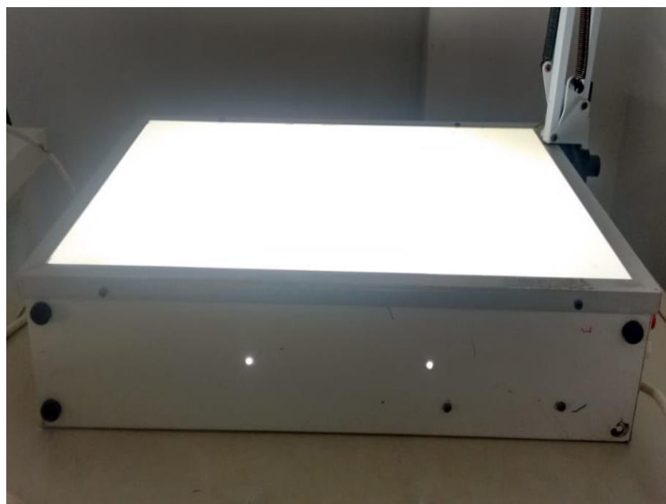
Figura 8. Fuente de luz usada para la visualización de cristales de hielo. Fuente: Elaboración propia
