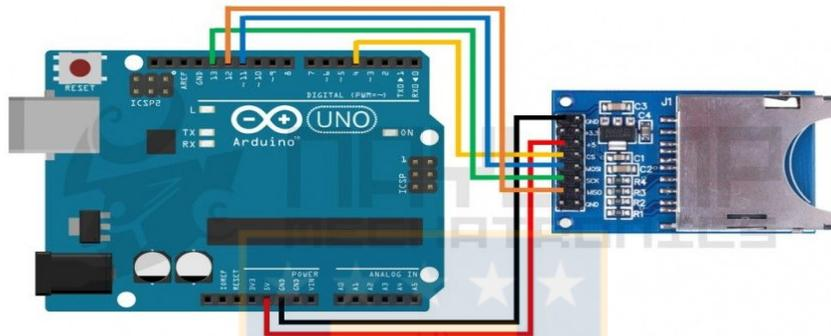
Figura 9. Esquema de conexión módulo SD.
