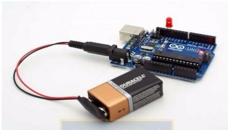
Figura 11. Batería y Adaptador.
