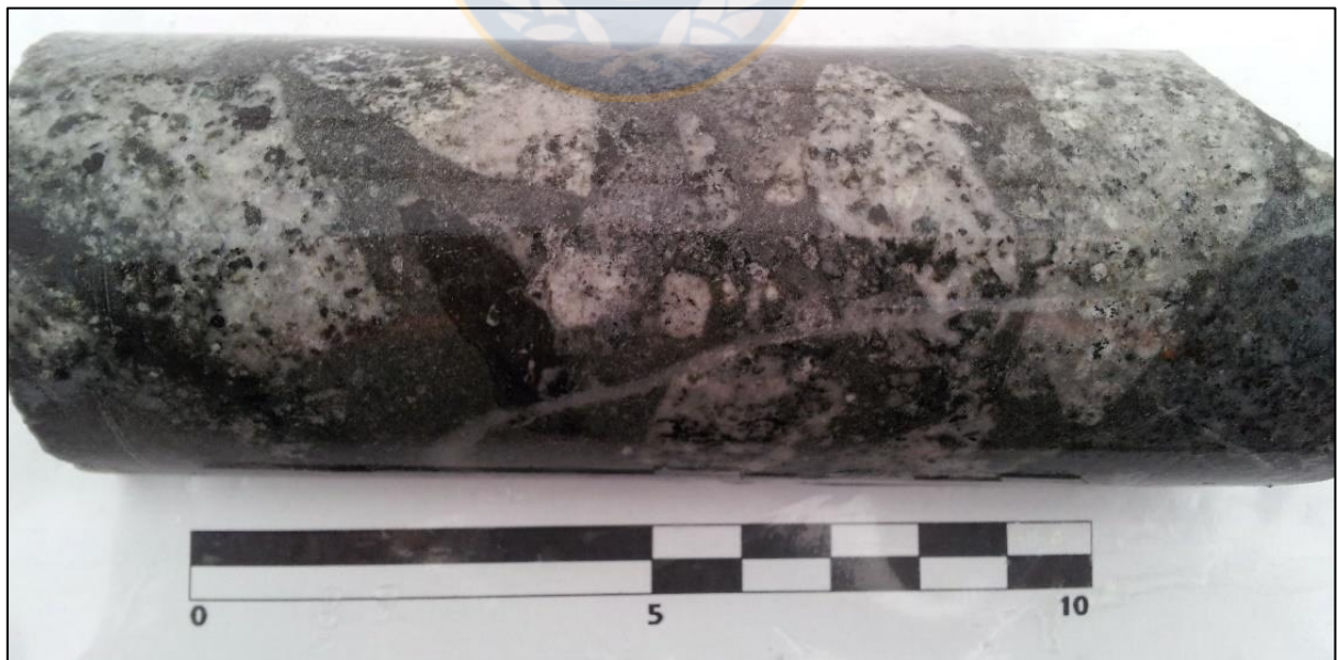
Fotografía 2: Testigo de sondaje diamantino con muestra de Brecha Infiernillo, donde se aprecian los clastos subangulosos de andesita y cuarzo monzonita.
