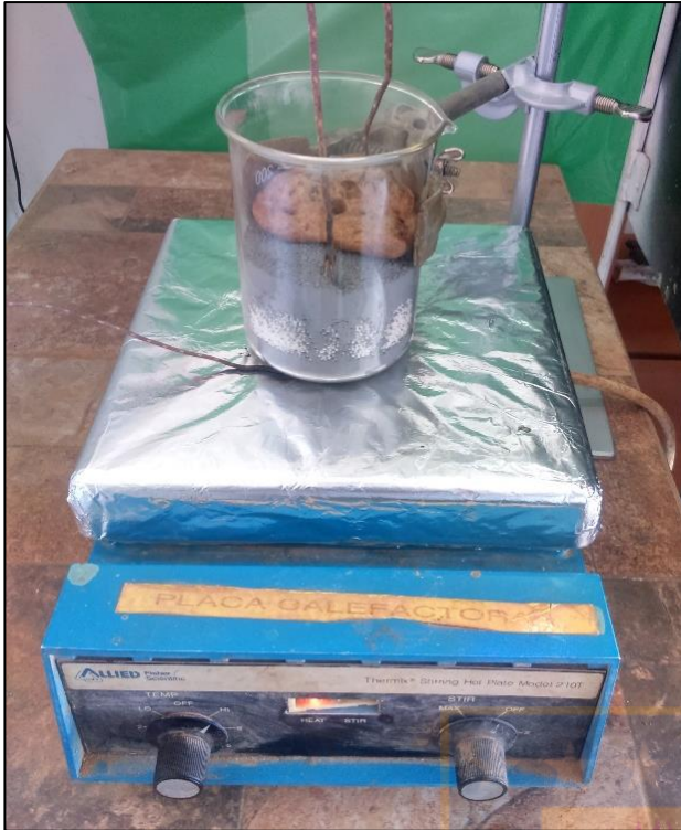
Fotografía 4: Inicio de reacción, con liberación de burbujas y espuma en un Ensayo de Reactividad.
