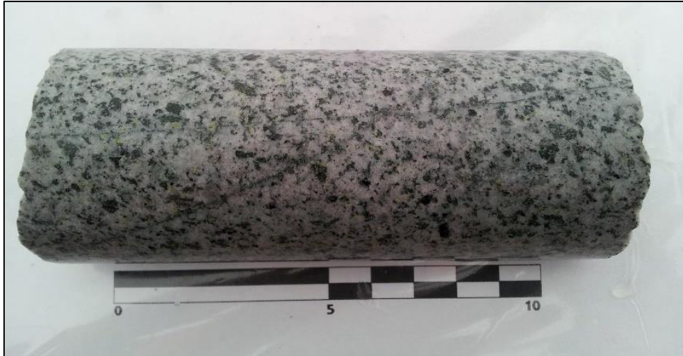
Fotografía 1: Testigo de sondaje diamantino con muestra de la unidad Cuarzo Monzonita.
