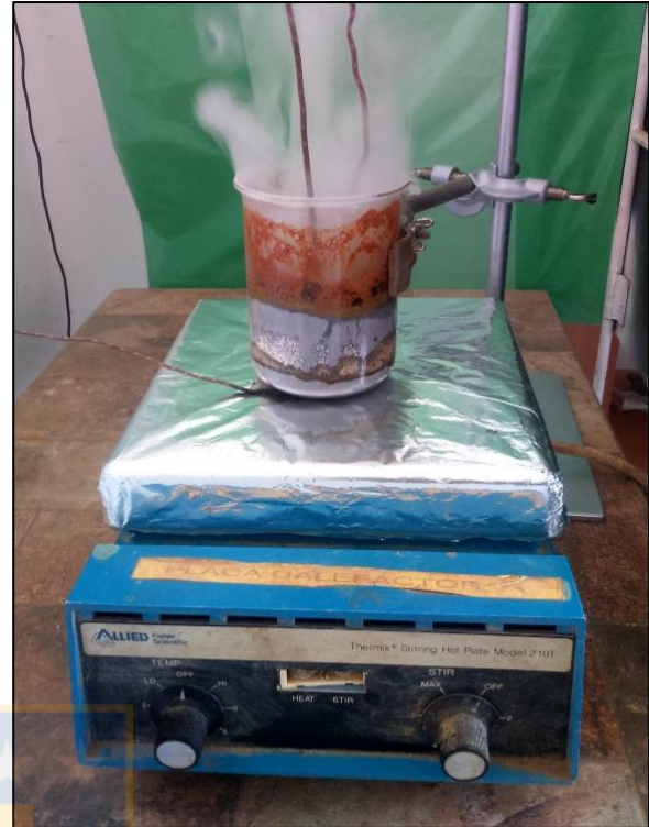
Fotografía 5: Reacción avanzada, con liberación de humos y espuma en un Ensayo de Reactividad.
