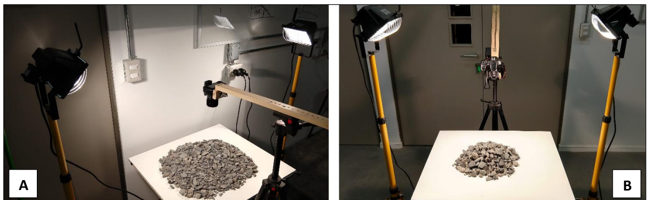
Figura 3.3: Disposición del material en ambas etapas de prueba: A) En plano. B) En pila.
