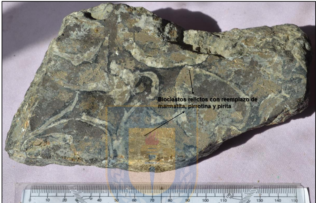
Fotografía 4.1. Muestra de Roca de Mina Aserradero. Se observan bioclastos con reemplazo parcial de mineralización de marmatita, pirrotina y pirita. Alteración principal de piroxeno y anfíbol en matriz.
