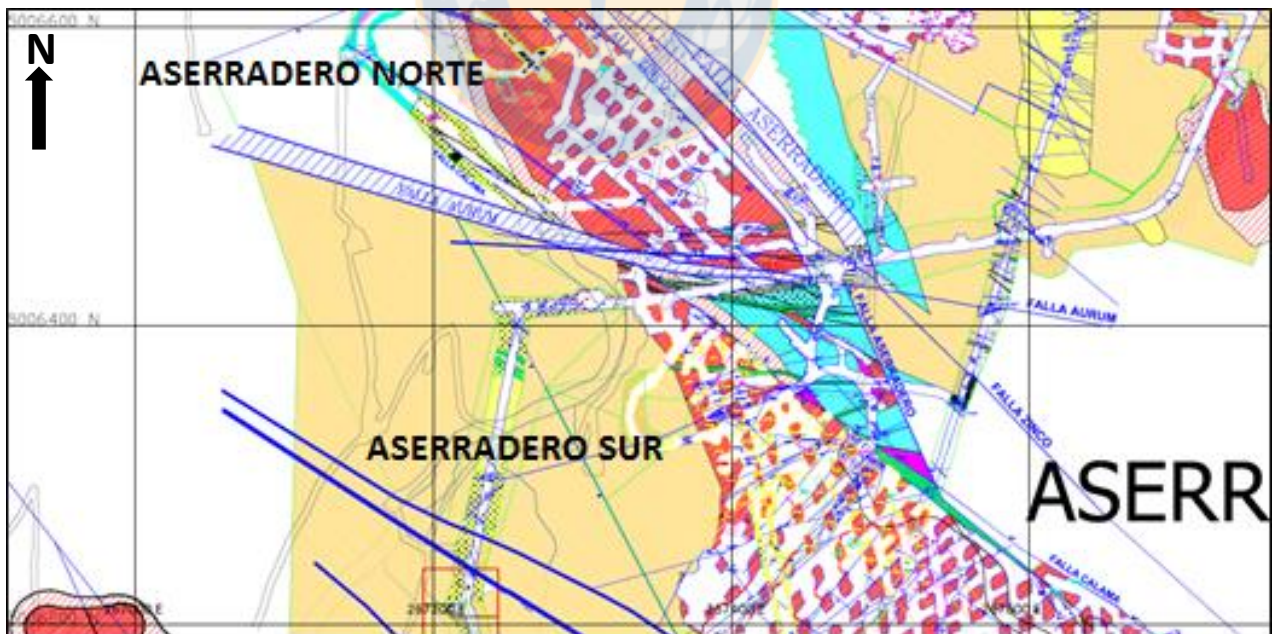
Figura 4.8: Mapa del Sector de Mina Aserradero Norte y Sur. Se expone, en línea azul, las principales fallas de primer orden de rumbo preferente NW-SE. Tomado de Mapa Geológico de Mina, 2012.
