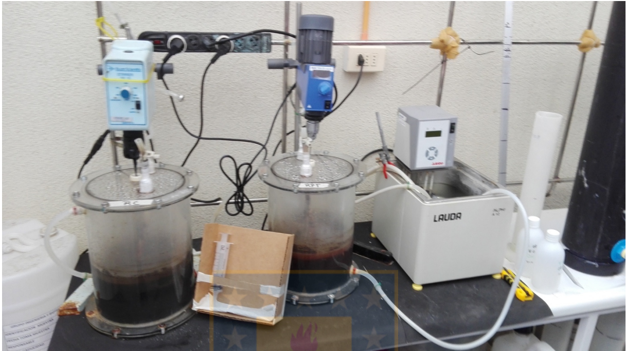
Figura 9. Reactores Anaeróbicos a escala de laboratorio presentes en el laboratorio de GIBA.
