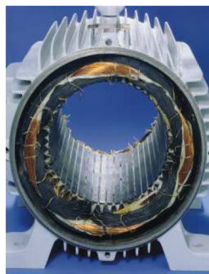
(k) Falla fase conexión estrella.
