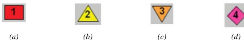
**Figura 2.3.6.1** (a) Alarma con prioridad 1, (b) Alarma con prioridad 2, (c) Alarma con prioridad 3 (d) Alarma con prioridad 4.
