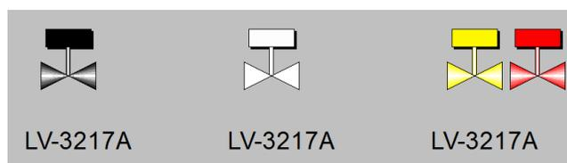
**Figura 4.3 Elementos de animación relevantes: válvulas solenoides.**
