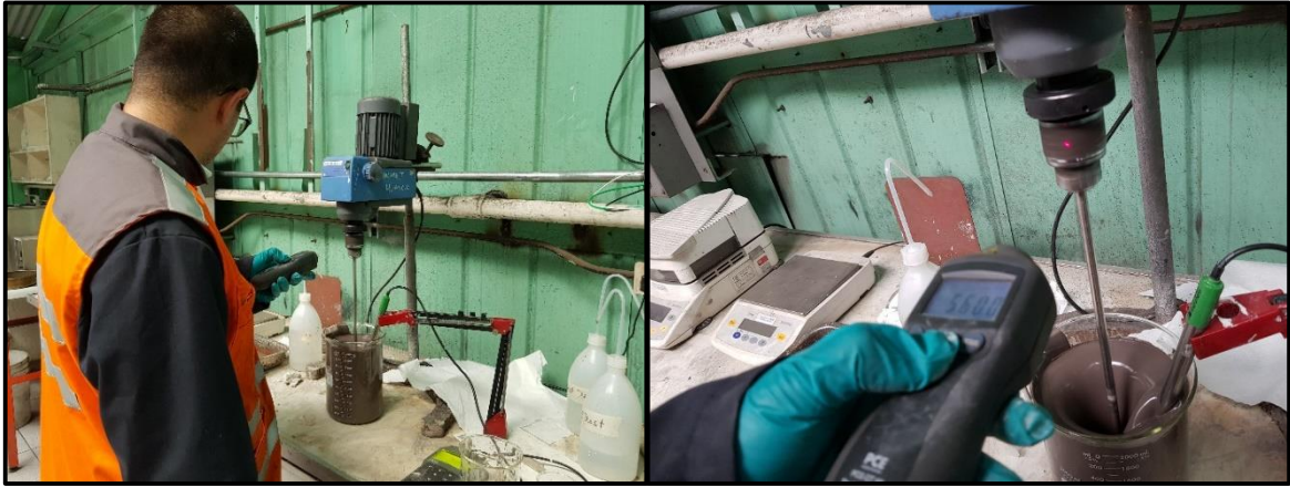
Figura 19: Agitador mecánico y tacómetro medición rpm
