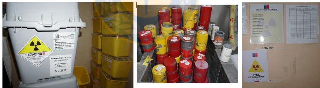
Figura 23: Bodega interna de acopio transitorio de residuos radiactivos.
