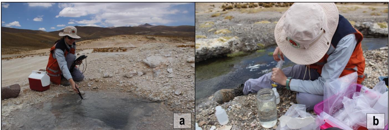
Figura 4.2. Metodología de toma de muestras de agua. a) Medición de parámetros fisicoquímicos in situ . b) Recolección de agua y filtrado.
