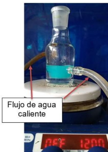
Figura 3-2. Reactor en el cual se realizaron los experimentos de extracción.
