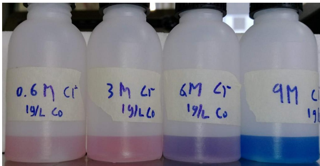
Figura 4-7. Soluciones acuosas de 1 g/L de Co(II) a diferentes concentraciones de ácido clorhídrico.
