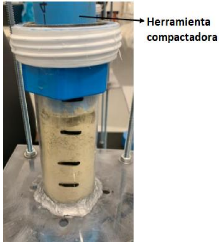
Ilustración H1: Compactación por ensayo proctor modificado
