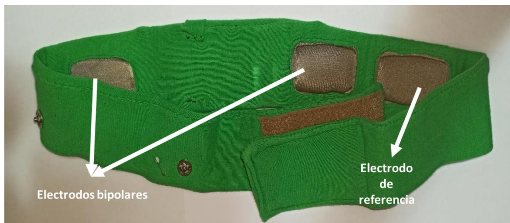
Figura 3-5 : Cinto medidor de ECG (elaboración propia)
