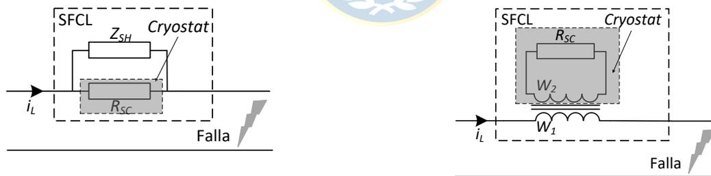
**Fig. 1.4.** Diferentes tipos de FCL basados en superconductores (SFCL)
