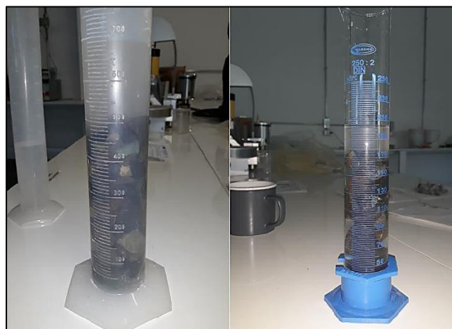
Figura 3.2. Ejemplo medición de densidad por desplazamiento de líquido [35].
