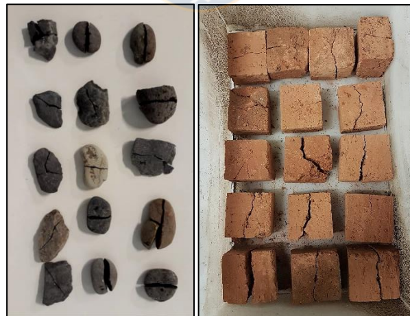
Figura 3.7. Testigos posteriores a ensayos de carga puntual.
