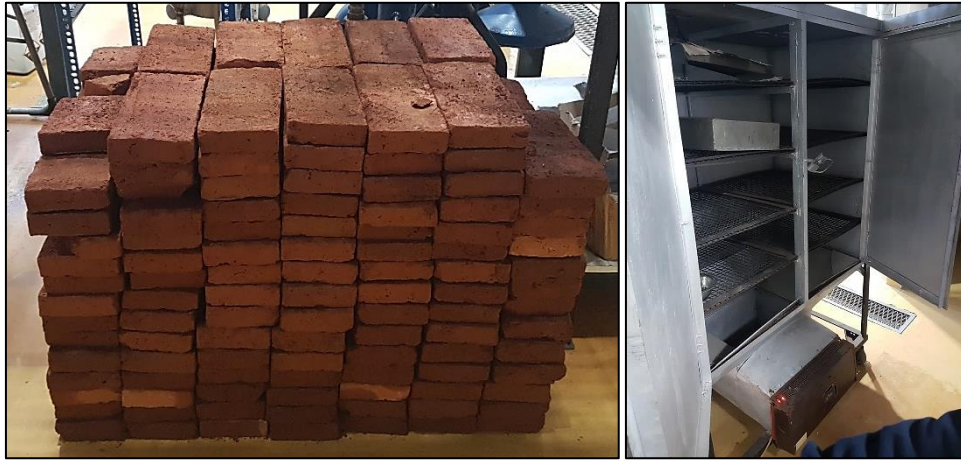
Figura 3.12. Ladrillos húmedos y horno industrial.
