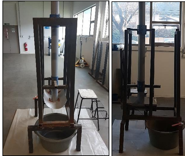
Figura 3.11. Modelo a escala de un pique de traspaso.
