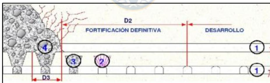
Figura 2. Esquema de construcción de Hundimiento Convencional [4]
