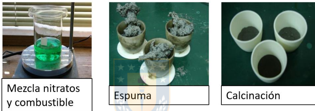
Figura 4.3: Etapas síntesis del compuesto NiO-GDC.
