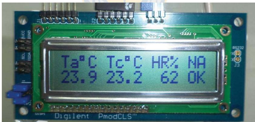
Fig. 7.6 Información de la pantalla situada dentro de la incubadora.
