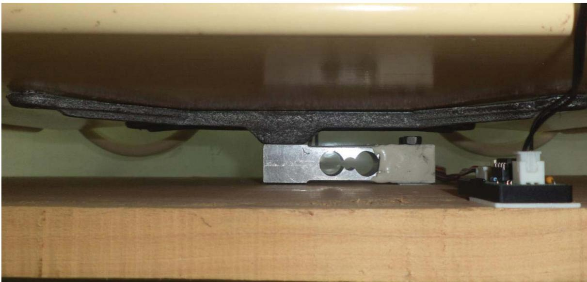
Fig. 7.7 Vista del colchón anexo al sensor de peso.
